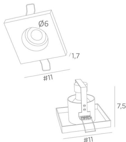
**ORLANDO** est un spot-plafond à encastrer dont l'ampoule GU10 est intégrée en profondeur dans un boîtier carré tout en épaisseur
