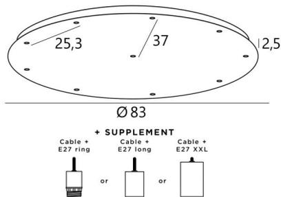
**CEILING BASE 11 o38** est une base-plafond de forme ronde, prévue pour onze sorties de câbles en vue de suspendre des ampoules, des structures, des verres ou des abat-jour. En supplément, il est possible d'y adjoindre onze câbles recouverts de textile et terminés par une douille. Il existe de nombreuses options pour le choix des finitions de la base, des douilles, des couleurs ou des longueurs de câbles
