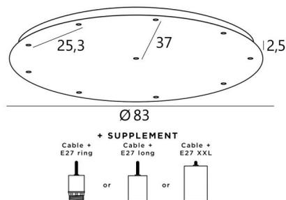
**CEILING BASE 10 ø83** est une base au plafond de forme ronde, prévue pour dix sorties de câbles en vue de suspendre des ampoules, des structures, des verres ou des abat-jour
