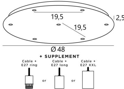
**CEILING BASE 7 o48** est une base au plafond de forme ronde, prévue pour sept sorties de câbles en vue de suspendre des ampoules, des structures, des verres ou des abat-jour. En supplément, il est possible d'y adjoindre sept câbles recouverts de textile et terminés par une douille. De nombreuses options pour le choix des finitions de la base, des douilles, des couleurs ou des longueurs de câbles
