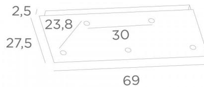
**CEILING BASE 5 #** est une base au plafond de forme rectangulaire, prévue pour cinq sorties de câbles en vue de suspendre des ampoules, des structures, des verres ou des abat-jour
