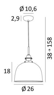
SUPERNOVA est une suspension, de style "rétro" avec une coupole de 26cm de diamètre Sa coupole en laiton repoussé est surmontée d'un cache-douille tout en métal qui lui apporte ce style ancien. Le travail de fabrication de la coupole est impressionnant et seule la technique du repoussage a permis de réaliser cette petite merveille de laiton
