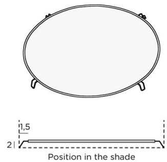
Diffuseur avec crochets en Polycrystal (matière de catégorie 1)
