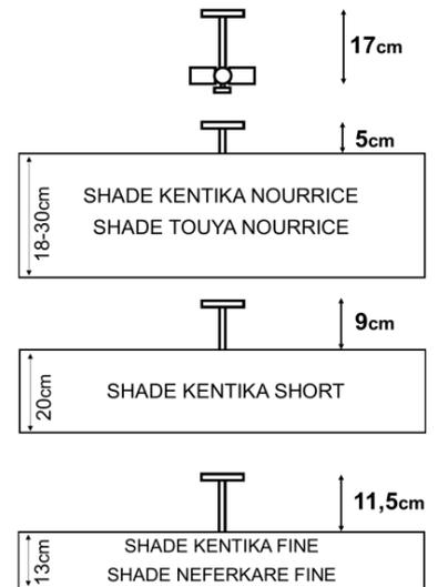
**KENTIKA NOURRICE** est un plafonnier prévu pour suspendre de nombreux abat-jour munis une attache spéciale pour le placement sur une nourrice. La fixation de l'abat-jour au plafonnier se fait au moyen d'une grosse vis de serrage. Voir le dessin ci-dessus
