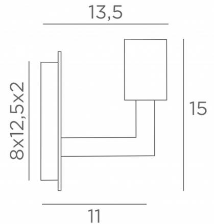
**SAHOURE L** ist eine Wandleuchte, in die nur eine dekorative Glühbirne eingesetzt werden kann. Diese Wandleuchte kann auch umgekehrt mit der Glühbirne nach unten angebracht werden. Sie ergänzt eine bereits installierte Pendelleuchte mit dekorativen Glühbirnen. Ein ähnliches Modell mit einem Ring an der Fassung ist für die Anbringung eines **KERMA-Struktur** oder eines traditionellen Lampenschirms vorgesehen, siehe **SAHOURE**.
