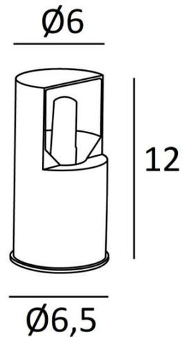
**UP 112** ist eine kleine indirekte Beleuchtung, die auf ein Regal oder einen Schrank gestellt werden kann. Das Licht ist nach oben gerichtet, aber auch nach hinten, dank einer Kerbe, die die Glühbirne an der Seite freigibt.
