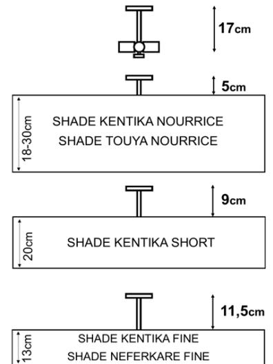
**KENTIKA NOURRICE** ist eine Deckenleuchte, an der zahlreiche Lampenschirme aufgehängt werden können, die mit einer speziellen Befestigung, für die Anbringung an einem NOURRICE versehen sind. Siehe die Zeichnung oben. Die Befestigung des Lampenschirms an der Deckenleuchte erfolgt mit einer großen Klemmschraube
